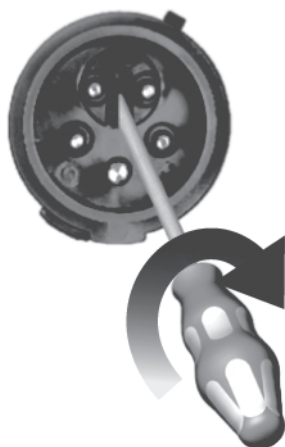
Рис. 13 Смена фаз трёхфазного шкафа управления (< 5 кВт) с фазовым инвертером
